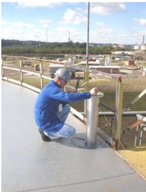
Figura 11 – Técnica da fita métrica (Medidas externas) – Altura de referência
