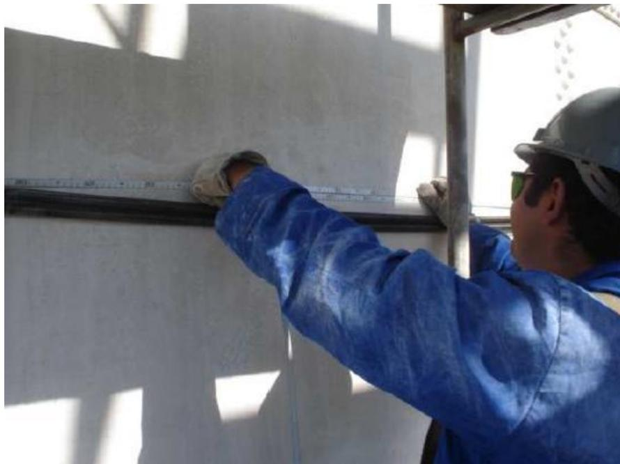
Figura 10 – Técnica da fita métrica (Leitura da circunferência) – Trena topográfica
