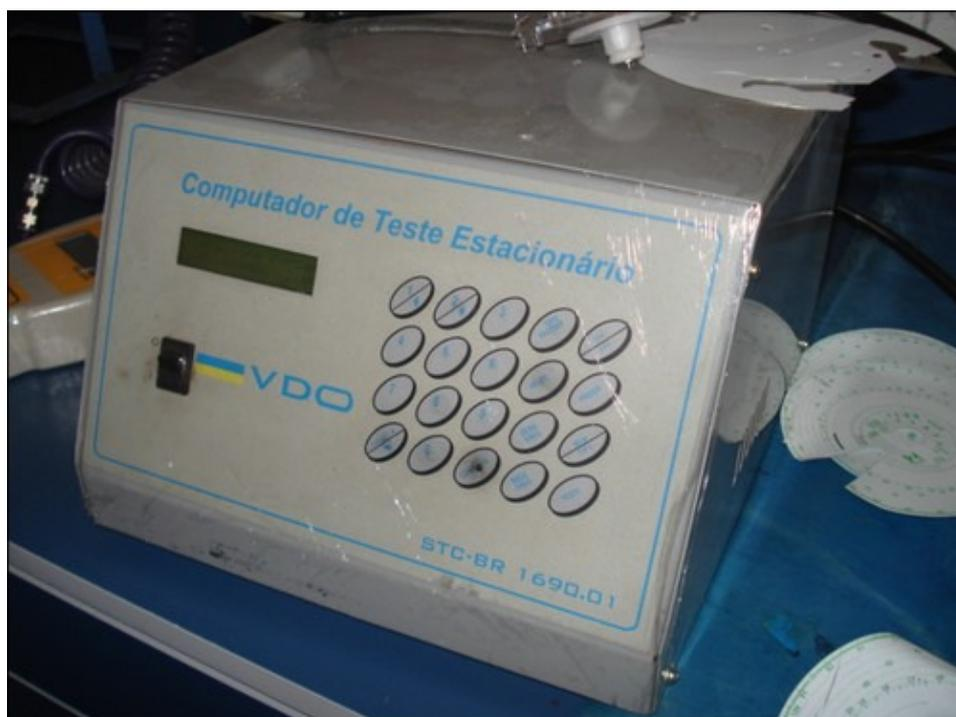
FIGURA 11 - EQUIPAMENTO UTILIZADO NO TESTE DE BANDCADA DE CRONOTACÓGRAFOS
