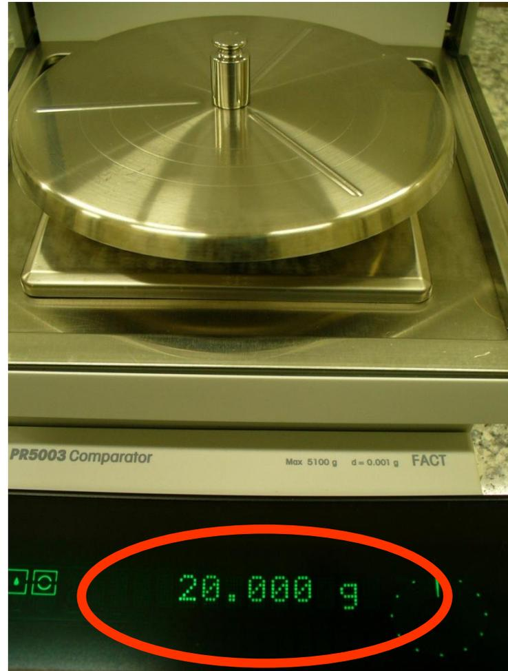
**Mas, se utilizarmos um peso de 20 g da classe M3 que pode apresentar um erro de até 0,025 g, valor superior a resolução da balança, o erro poderá ser detectado. Neste caso o operador, sem um certificado de calibração, não saberá se o erro é da balança ou do padrão.**
