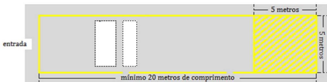
**Figura 3 - Pista de Ensaio com Simulador de Pista**
