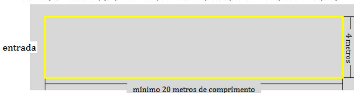
**Figura 1 - Pista Auxiliar**
